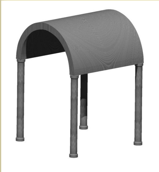
Abóbada de Berço
